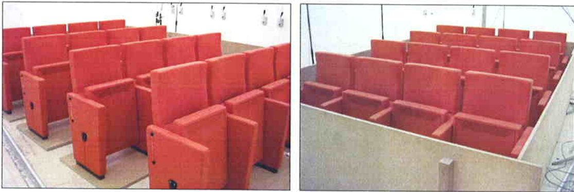
Imágenes 1 y 2 Colocación de las butacas en la sala reverberante y cerramiento perimetral
