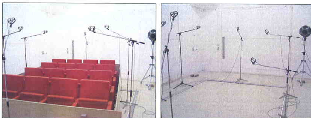
Imágenes 7 y 8 Medición de la muestra sin la espuma y de la sala reverberante vacía
