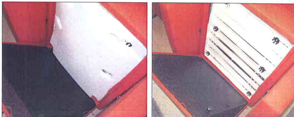
Imágenes 5 y 6 Butaca con y sin la espuma de poliuretano en el interior, respectivamente
